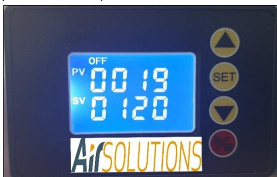
La riga indicata con PV indica il tempo di ritardo con il quale si avvierà il ciclo di trattamento con ozono per permettere all'operatore di allontanarsi dalla zona in cui si avvierà il trattamento
