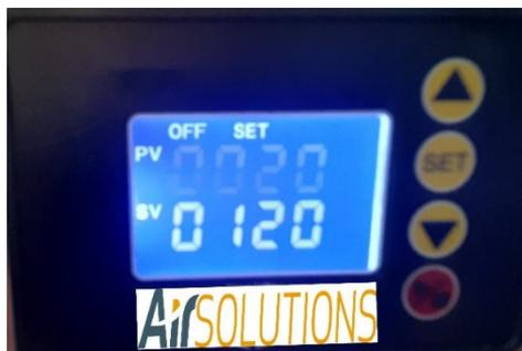
Premendo due volte il tasto "SET" inizierà a lampeggiare la seconda riga, agire sul tasto ▲ o sul tasto ▼ per aumentare o diminuire il valore impostato.
